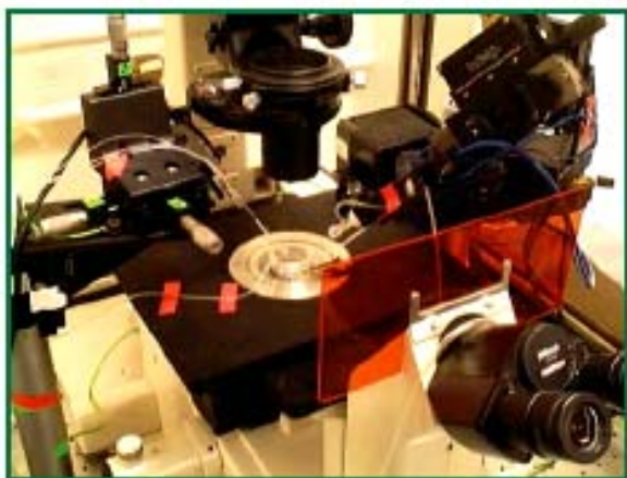
用来监测在突触发生的微小的电压的仪器。
